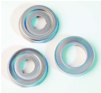
Rasierkappen sind Werkstücke, die sich ideal per ECM erodieren lassen.
