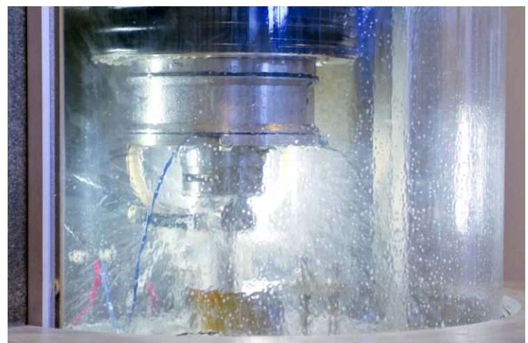
Im Bild ein ECM-Prozess mit Druck-/Spülkammer.
